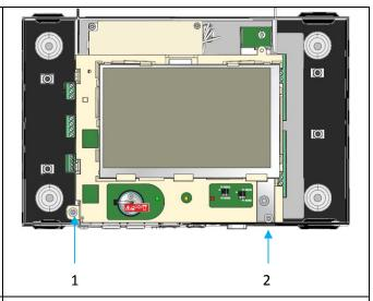
Schieben Sie die CPU/Displayeinheit an der mittleren Displaylasche (**Kennzeichnung 1**) nach oben. Sie könnten diese nun nach vorne entfernen.
