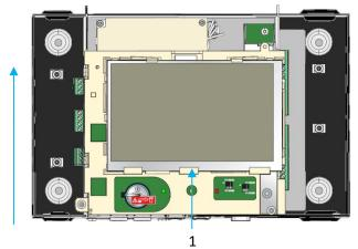
Die SD Karte befindet sich auf der Rückseite der CPU/Displayeinheit. Diese wird durch leichtes Drücken auf die Oberkannte der SD Karte entriegelt und durch eine Feder nach außen gedrückt. Sie kann anschließend leicht entnommen werden.
