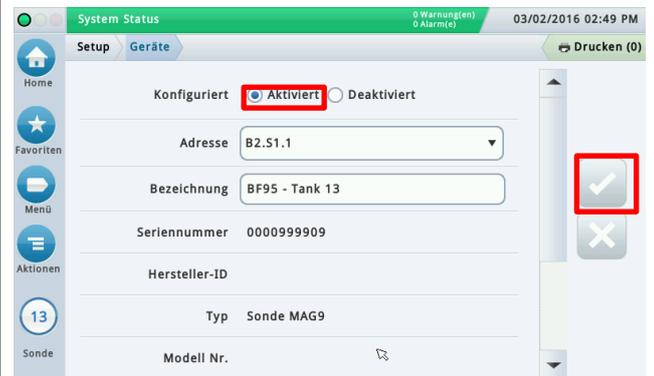
9 Wenn alle Eingänge des TLS4 USM mit Sonden belegt sind erhält die an B2.S1.2 angeschlossene Sonde die Nummer 14.
