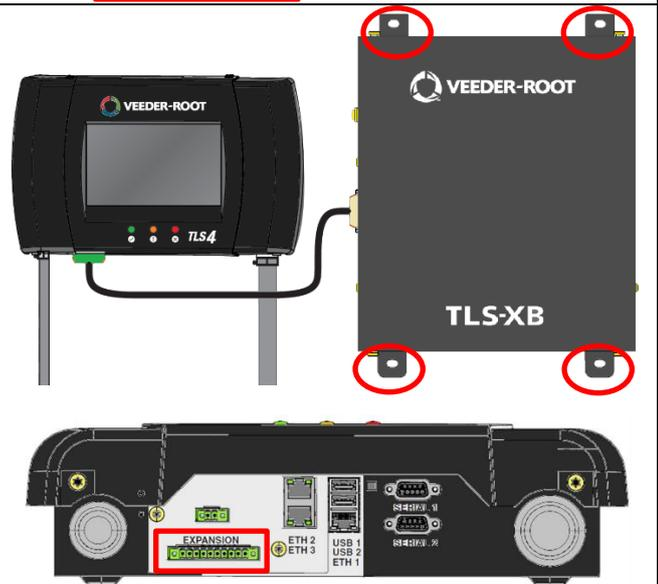
6 Nachdem alle Sonden & Sensoren richtig angeschlossen wurden muss das TLS4 neu gestartet werden. Die TLS-XB Box wird über das Anschlusskabel von der TLS4 Konsole mit Strom versorgt.
